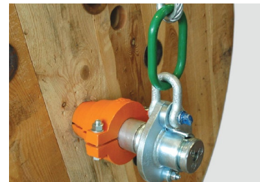
Beispiel einer Wellenaufhängung mit Zentrierkone; Fa. Vetter
